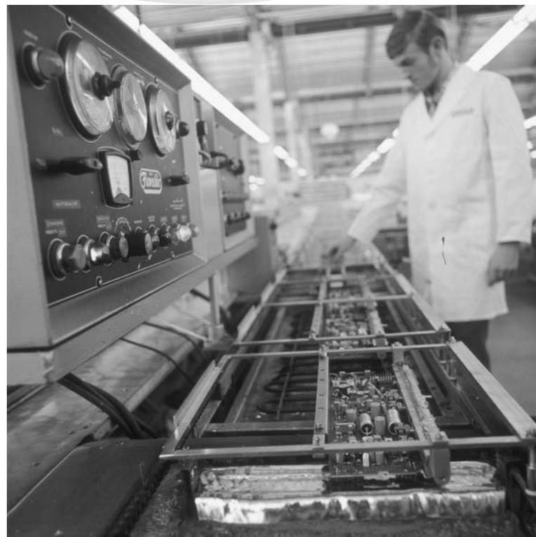
*Die Lötanlage im Werk Asch-Leeder*
