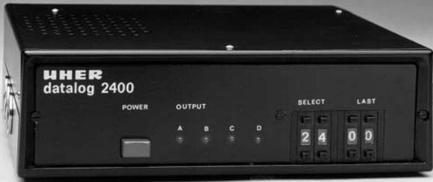
Die Aufzeichnung erfolgte Autorevers mit Hilfe eines 2/2-Spur Kopfes, d. h. es wurde vorwärts auf Spur 1 aufgezeichnet, bei Spur 1-Ende automatisch auf Spur 2 umgeschaltet und ohne Datenverlust im Rückwärtslauf aufgezeichnet. Bei Erreichen von Spur 2-Ende schaltete sich die Aufzeichnung automatisch ab. Die Cassettenkapazität betrug damit ca. 350.000 Zeichen. Die Aufzeichnungsgeschwindigkeit wurde aus der System-Clock abgeleitet und betrug 5461 bps bei einer Bandgeschwindigkeit von 6,8 ips.
