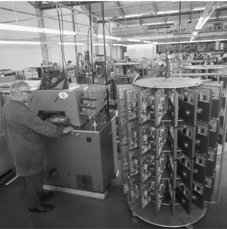
**Einprägen der Seriennummer in das ALU-Druckguss-Chassis**
