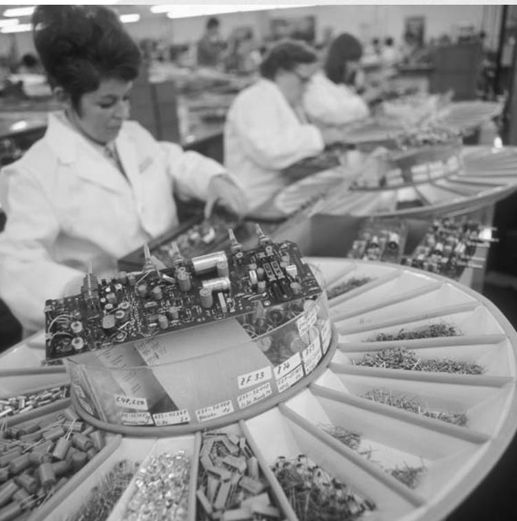
**Bestücken der Leiterplatten mit Elektronikbauteilen**
